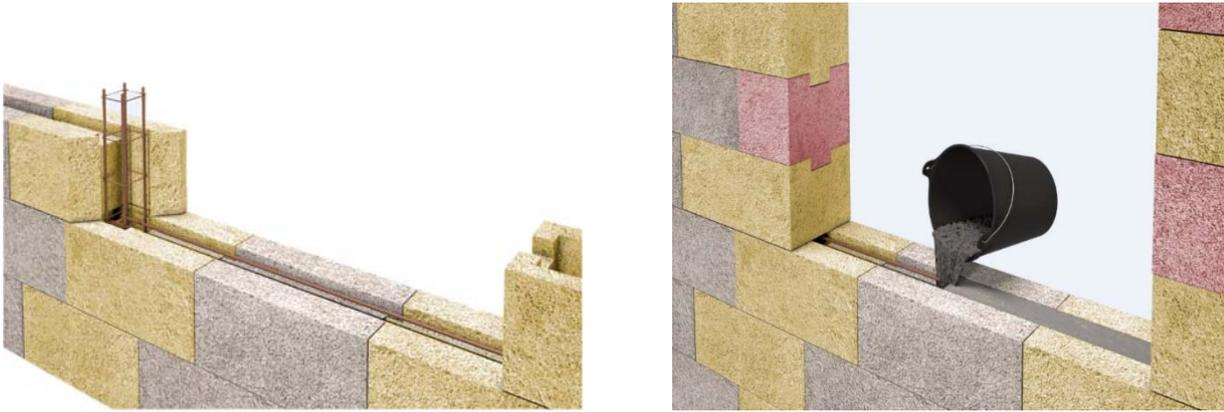
**Figure 14 – Principe de mise en œuvre des linteaux**
