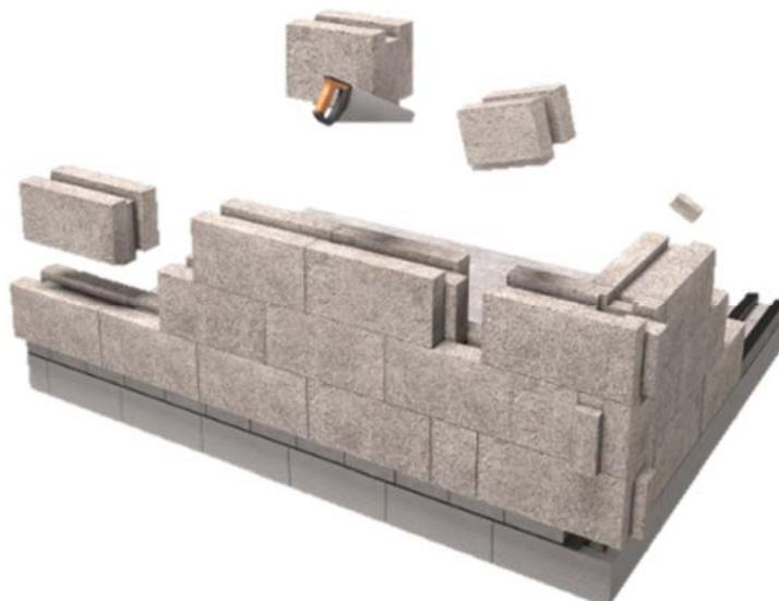
Figure 4 - Montage en mur courant avec espace restant inférieur à 10 cm
